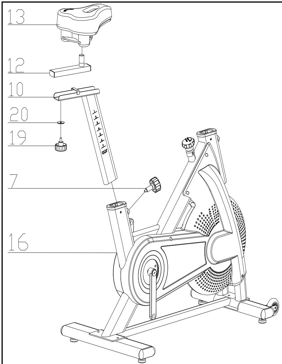
Сначала ослабьте и уберите регулировочную ручку (7), затем соединение (10) для того, чтобы отрегулировать стойку сиденья (16) основной рамы. Теперь установите стойку сиденья (16) в соответствующее положение, затем вставьте регулировочную ручку (7) на место. Установите раму сиденья (12) на направляющую (10), и затем вставьте регулировочную ручку (7), чтобы закрепить детали. Теперь, установите сиденье (13) и закрепите с помощью поперечного ключа.
