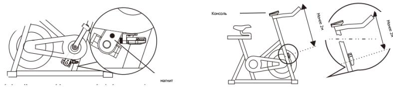
Установка ременного шкива или магнита кривошипа и беспроводного датчика (установка беспроводного датчика аналогична установке маховика).
