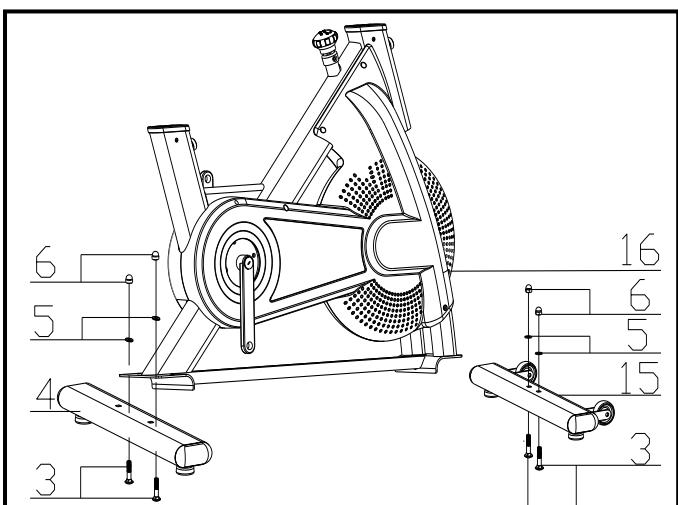
Установите передний стабилизатор (15) на основную раму (16) и закрепите с помощью двух плоских шайб Ø8 (5), гайки M8 (6) и болта (3).
