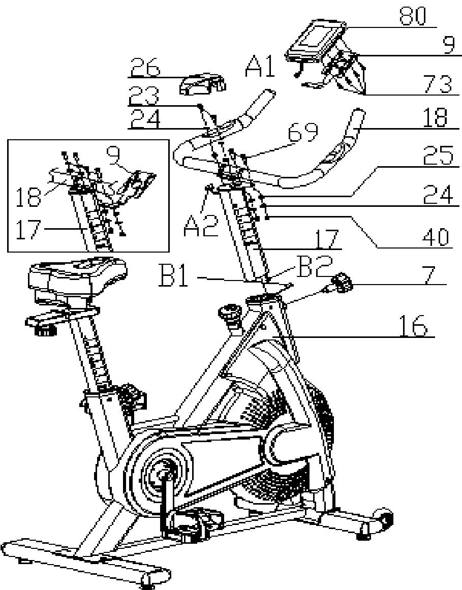
Сначала ослабьте и уберите регулировочную ручку (7). Затем отрегулируйте положение вертикальной стойки руля (17) на основной раме (16), чтобы установить нужное положение. Затем вставьте регулировочную ручку (7) на место и зафиксируйте.
