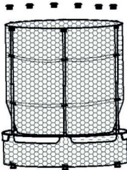
**4.3** Подсоедините детали Р и F проведя их сквозь нижние отверстия в конструкции батута и зафиксируйте их деталями H.
