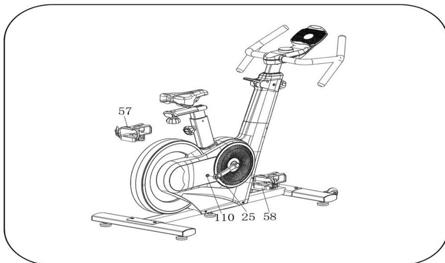
1. Сначала раскрутите стопорную гайку на левой педали (109), затем установите левую педаль (57) на левую рукоятку (24), с помощью поперечного ключа (113) и ранее снятой о стопорной гайки зафиксируйте детали. Установите правую педаль (58) таким же образом.
