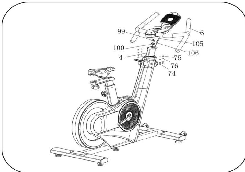
1. Соедините сигнальный кабель консоли (99) и кабель, выходящий из стойки руля (100); Соедините линию консоли (105) и линию стойки (106), а затем установите руль на вертикальную стойку.
