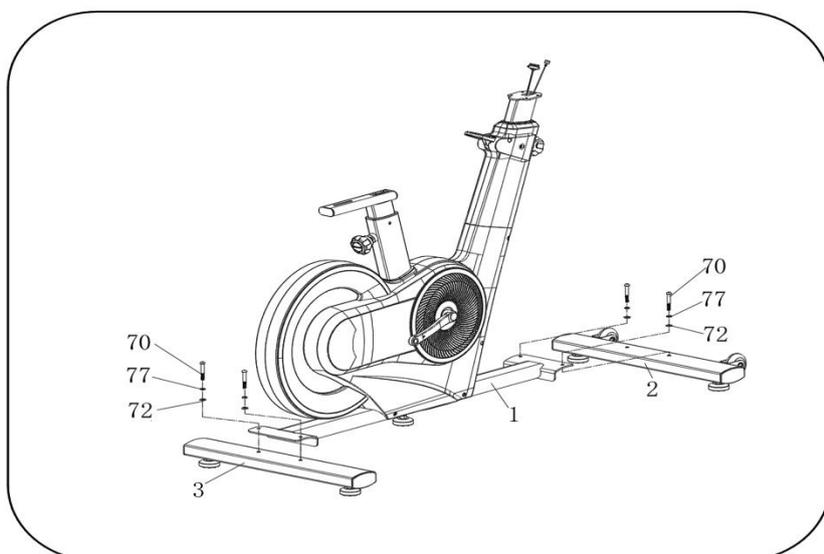
1. Зафиксируйте раму в сборке (1) с помощью шестигранного ключа 5# (111), шестигранного винта (70), стандартной пружинной шайбы (77), плоской шайбы (72) и переднего стабилизатора (2), а затем также установите задний стабилизатор (3).
