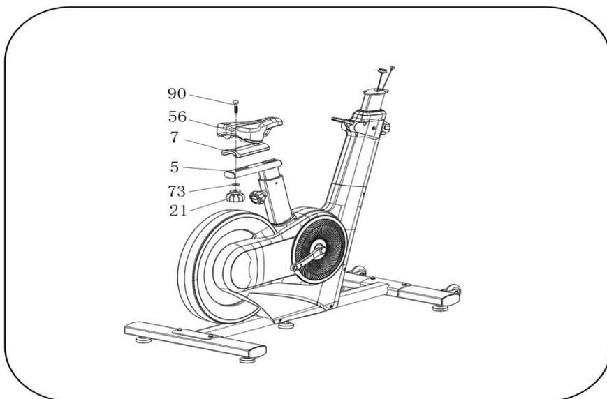
1. Установите сиденье (56) на регулировочную пластину сиденья (7) и опорную стойку (5), закрепите детали с помощью болта (90);
