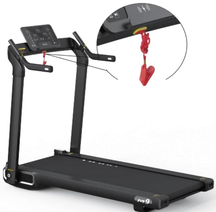
Как показано на рисунке, установите ключ безопасности (72) в соответствующее отверстие на консоли, зажим на красном тросике должен быть надежно закреплен на одежде во время тренировки, чтобы немедленно снять ключ и остановить беговую дорожку.
