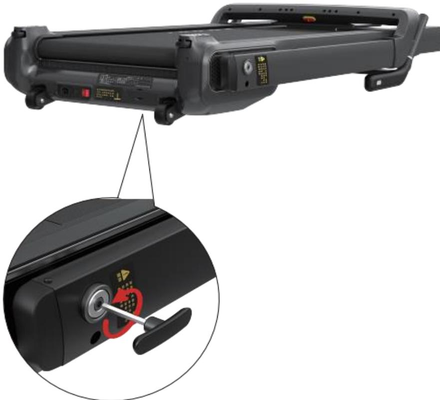
Как показано на рисунке, с помощью ключа (57) ослабьте два винта М8\*105 с левой и правой стороны беговой дорожки (по 5-6 оборотов с каждой стороны), чтобы поднять вертикальную стойку.
